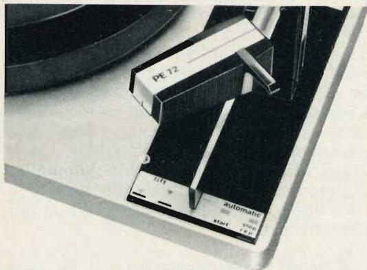
Fig. 2 - Quadro di comando del PE 72.
